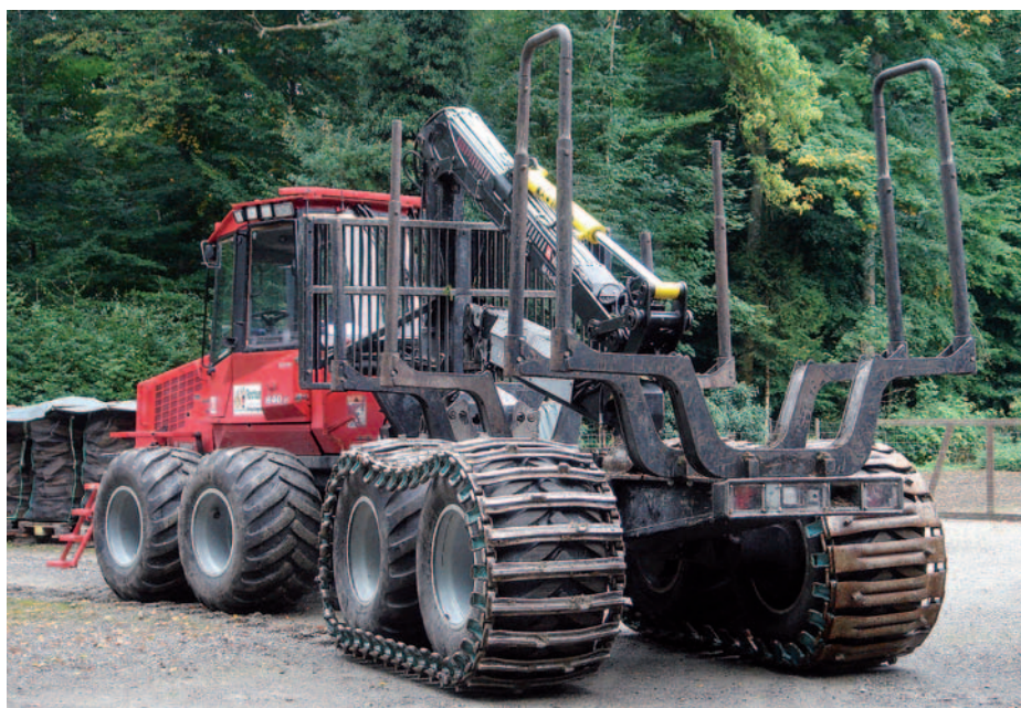
Fig. 13. Ce porteur forestier a été équipé, à des fins de démonstration, de deux types différents de semi-chenille Bogie: à gauche des semi-chenilles de traction destinées à améliorer les performances en montée et la sécurité en pente, à droite des semi-chenilles portantes permettant de préserver les sols à faible portance, sur terrains plats ou légèrement inclinés.
