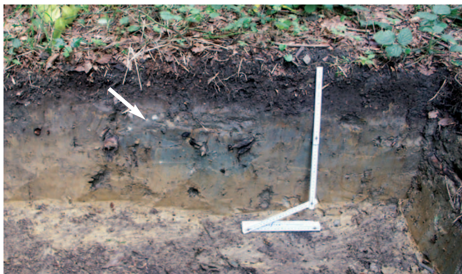
Fig. 4. Ornière avec caractéristiques d'hydromorphie. Les couleurs de réduction (gris-bleu) et les taches couleur rouille indiquent une aération limitée du sol. Le passage d'engins est à l'origine de la réduction du volume des pores et de l'interruption des connexions entre eux.
