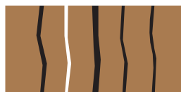
Fig. 5. Le passage d'engins provoque des modifications dans le sol. L'affaissement du sol entraîne une réduction du volume des pores larges. Les pores du sol sont, dans le cas d'un cisaillement, décalés les uns par rapport aux autres et ne communiquent plus entre eux. Pétrissage/malaxage signifie que la structure du sol est complètement détruite (Source: TOBIAS et al. 1999, modifié).
