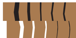
Fig. 5. Le passage d'engins provoque des modifications dans le sol. L'affaissement du sol entraîne une réduction du volume des pores larges. Les pores du sol sont, dans le cas d'un cisaillement, décalés les uns par rapport aux autres et ne communiquent plus entre eux. Pétrissage/malaxage signifie que la structure du sol est complètement détruite (Source: TOBIAS et al. 1999, modifié).
